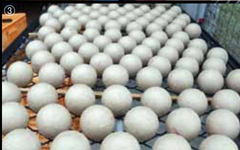
花火作り ①花火に色を付ける炎色剤。火薬と混ぜあわせて主要部品の「星」を作ります。②玉の内側に「星」をつめます。③半月状の②をふたつ、紙テープでくっつけて完成です。
