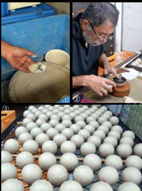
花火作り ①花火に色を付ける炎色剤。火薬と混ぜあわせて主要部品の「星」を作ります。②玉の内側に「星」をつめます。③半円状の②をふたつ、紙テープでくっつけて完成です。
